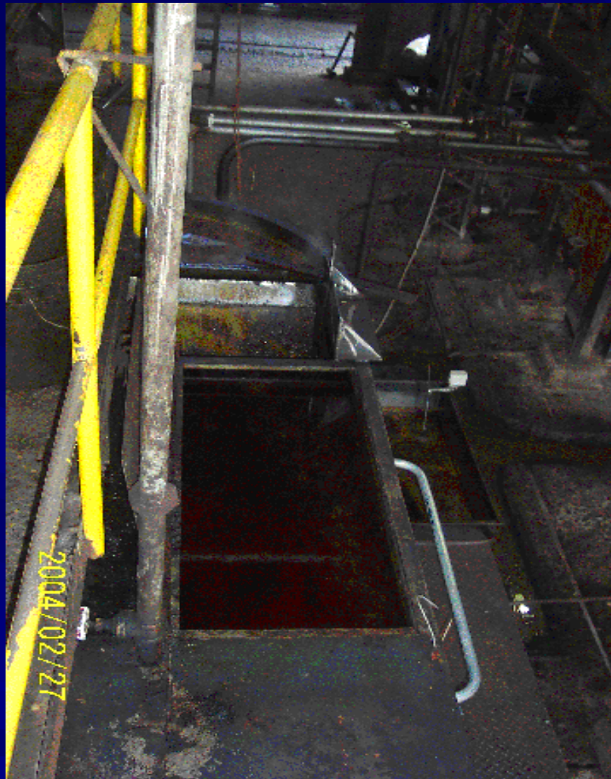
Tanque de clarificación (separación agua aceite)
