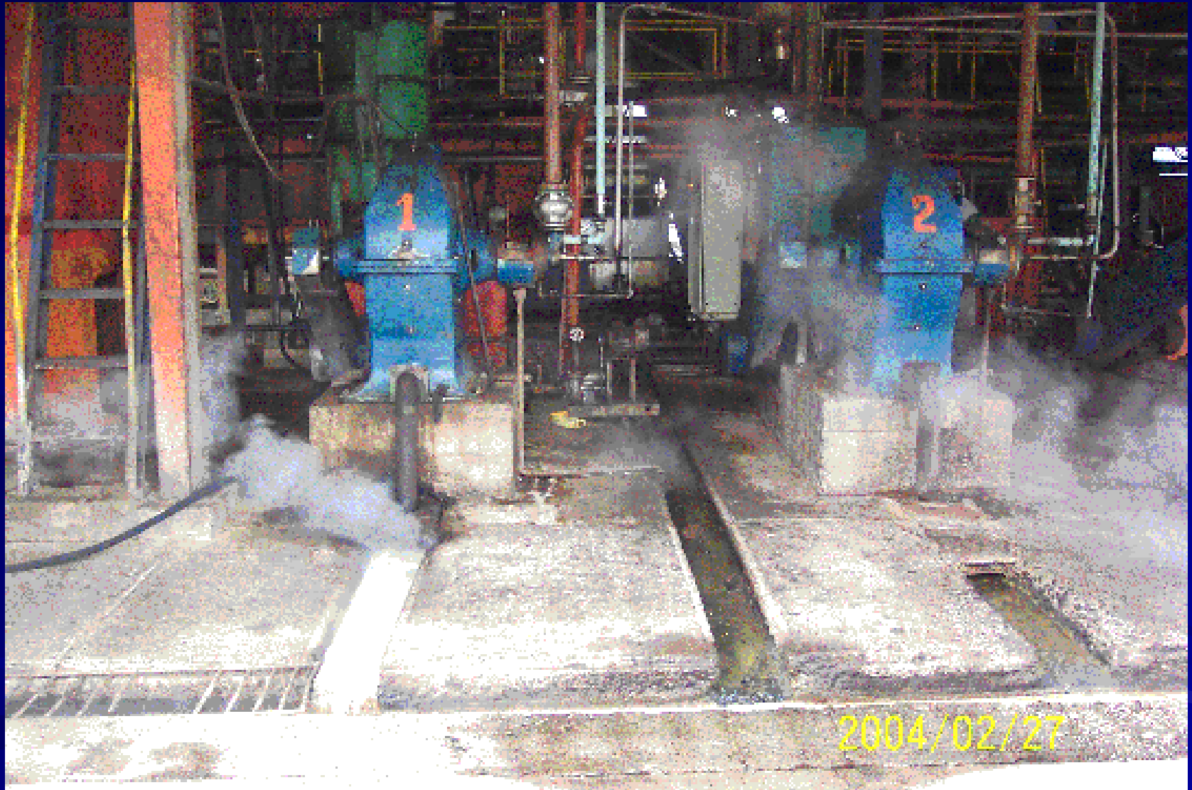
Centrifugas para separación agua aceite
